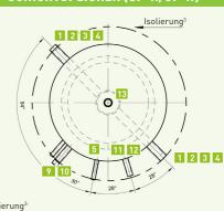
Typ 600: Ø 950 mm, Typ 800: Ø 1040 mm, Typ 1000: Ø 1040 mm
