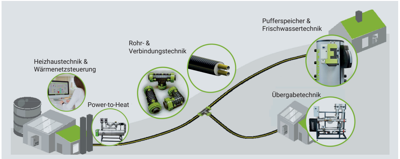
Bild 3. Ganzheitlicher Ansatz: Smarte Steuerung der Nahwärmepufferspeicher samt preiswerten aramidverstärkten PE-Xa-Nahwärmeleitungen
