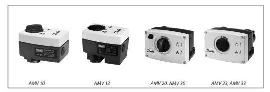
Die Stellantriebe mit Sicherheitsfunktion (AMV 13, AMV 23 oder AMV 33) und ohne Sicherheitsfunktion (AMV 10, AMV 20 oder AMV 30) werden hauptsächlich in Kombination mit den Ventilen VS, VM, VB, AVQM und VMV (nur mit AMV 10) eingesetzt. Bei Stromausfall oder bei Abschaltung der Stromversorgung durch den Sicherheitsthermostat wird die Sicherheitsfunktion automatisch aktiviert. Die Stellantriebe passen den Hub automatisch an die Ventilendlagen an. Dies führt zu einer kürzeren Inbetriebnahmezeit.
